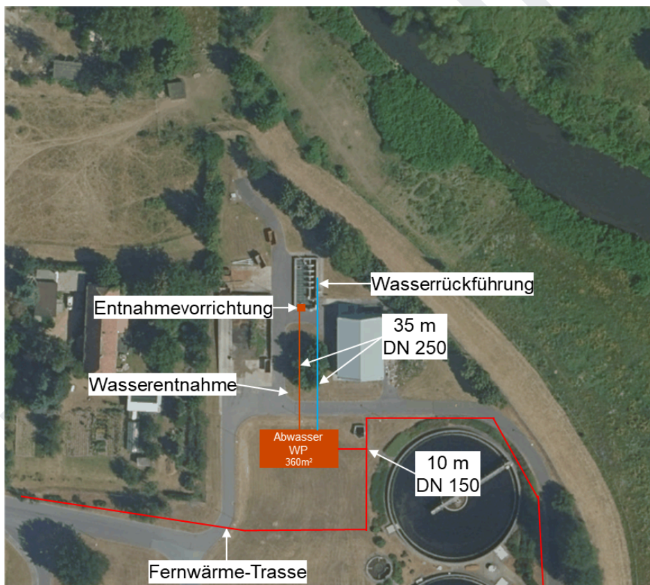
Abbildung 19: Geplanter Aufbau der Abwasser-Wärmepumpe
