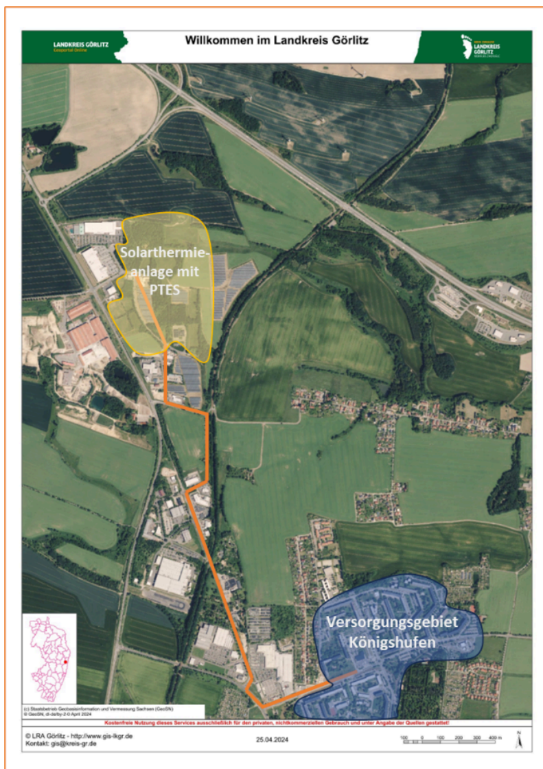
Abbildung 31: Geplante Anbindung der Solarthermieanlage an das Wärmenetz.
